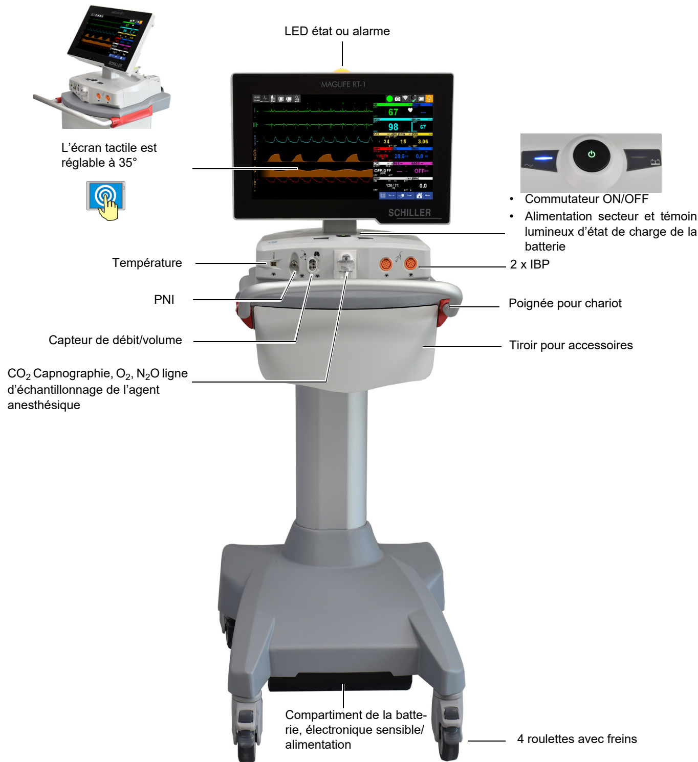
Fig. 2.1 Éléments de commande, face avant
