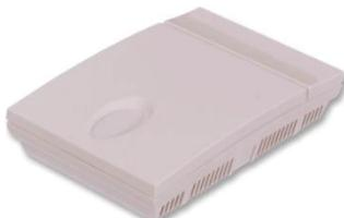
La sonde de pression salle et la sonde de pression SAS permettent de communiquer en temps réel la pression mesurée à l'armoire de traitement d'air. En fonction de la pression mesurée, l'armoire de traitement d'air fera varier le débit d'air du caisson motorisé d'air extrait pour maintenir en permanence la consigne de surpression souhaitée.
