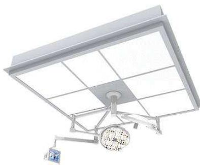
Le plafond à flux unidirectionnel permet d'assurer une vitesse de diffusion d'air comprise entre 0,25 et 0,35 m/s afin de garantir le meilleur compromis entre capacité d'épuration du système et confort. Le réglage du débit d'air se fera en mise en service dans les conditions de la consigne de la température en ambiance et le flux d'air devra descendre jusqu'au sol en atteignant une vitesse de 0m/s afin de ne pas remettre en suspension les particules au sol.
