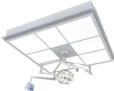
Le plafond à flux unidirectionnel permet d'assurer une vitesse de diffusion d'air comprise entre 0,25 et 0,35 m/s afin de garantir le meilleur compromis entre capacité d'épuration du système et confort. Le réglage du débit d'air se fera en mise en service dans les conditions de la consigne de la température en ambiance et le flux d'air devra descendre jusqu'au sol en atteignant une vitesse de 0m/s afin de ne pas remettre en suspension les particules au sol.
